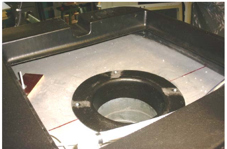
Abbildung 2.2: der Adapterring montiert in Kombination mit dem Dachadapter der ROOFTOP400.
